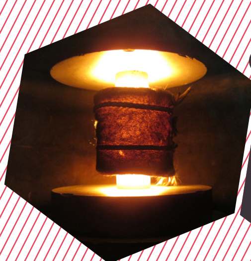
Sur cette photographie on distingue bien la feutrine qui entoure le moule en carbone. Le moule est blanc car il est à haute température.
